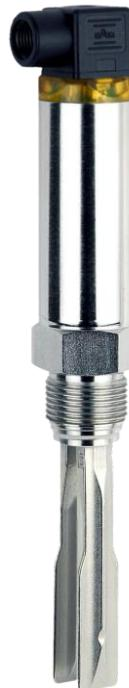
\* Princip rada - na osnovu piezoelektričnog elementa integrisanog u rezonantnoj viljušci i promene amplitudne oscilacija kada sonda uroni u materijal
